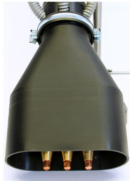
Der Luftstrom kann mit Hilfe eines integrierten Differenzdrucksensors gemessen werden. Si ist eine sichere Prozessüberwachung mit externer SPS möglich. Des Weiteren sind die Hauptteile in einem hitzebeständigen und nicht entflammaren Kunststoff 3D-gedruckt.
